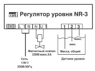
Кабель датчиков уровня можно удлинить экранированным проводом (2х0,75мм²) до 50 м. Непременно прокладывайте проводку водоустойчиво. Избегать прокладку кабеля датчиков в близи с силовыми кабелями изза возможных наводящихся помех.
