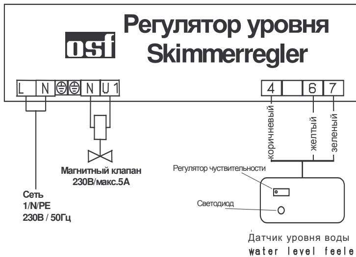
Кабель датчика уровня воды можно удлинять 4-жильным экранированным проводом. Непременно прокладывайте проводку водоустойчиво, во избежание утечек тока во влажной среде. Экран удлинителя соединить с экраном кабеля датчика (а также с зеленым проводом). В самом блоке управления экран не присоединять. **Избегать прокладку кабеля датчика в близи с силовыми кабелями из-за возможных наводящихся помех.**
